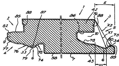
1. 一种用于设置地板的地板块，所述地板块为层压地板块（1），具有0.5cm至1.5cm的厚度，所述地板块（1）是矩形的，即细长的或正方形，并且所述地板块具有第一和第二对的相对的边（2-3, 26-27）、由MDF/HDF构成的中心部分（8）、装饰层（55）和底层（58）；其中至少第一对相对的边的边缘（2-3）处设有基本上形式为舌状物（9-31）和槽（10-32）的连接部分（4-5; 28-29），所述槽（10-32）由上部凸出部分（22-42）和下部凸出部分（23-43）界定，由此这些连接部分（4-5; 28-29）允许两个这样的地板块（1）可以相互连接，其特征在于，在所述第一对的边上，地板块（1）具有至少以下的附加特征：
