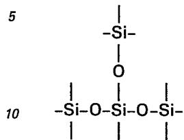
les autres valences des atomes de silicium étant reliées à des radicaux méthyles. Elles sont livrées en solution organique, le solvant de cette résine pouvant être du white-spirit, du butanol, un hydrocarbure aromatique ou aliphatique, de l'acétate d'éthyle, ou un mélange de ces produits.
