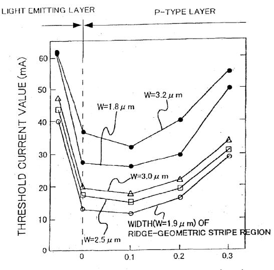
THICKNESS(d) OF RESIDUAL FILM (  $\mu$  m)
