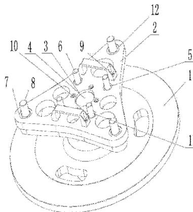
1. 一种模拟零件装配位置关系结构的综合检具,其特征在于:他包括底座(1),在所述底座(1)上方设有检具本体(2),在所述检具本体(2)中间设有大定位销孔(3),在所述大定位销孔(3)内设有大定位销(4),在所述大定位销(4)的四周设有四个固定式定位销孔(5),在所述固定式定位销孔(5)内设有固定式定位销(6),在所述检具本体(1)的每个角上设有活动式定位销孔(7),在所述活动式定位销孔(7)内设有活动式定位销(8)。
