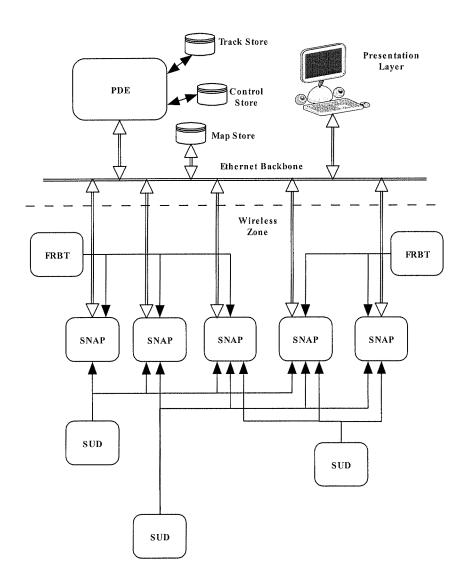
Figure 1– Subsystem Elements
