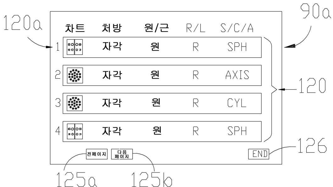
작성된 검사 시표의 화상 데이터를 기억시키는 기록 가능한 기억 매체와, 기억 매체에 기억된 화상 데이터를 장치에 입력하는 유닛으로서, 시표 선택 신호에 기초하여 기억 매체에 기억된 화상 데이터를 직접 호출할 수 있게 하거나, 또는 관독 신호에 의해 장치의 메모리 내에 화상 데이터를 복사하여, 시표 선택 신호에 기초하여 화상 데이터의 호출을 가능하게 하는 화상 데이터 입력 유닛과, 장치 메이커가 준비한 제 1 검사 시표 및 검사자에 의해 작성된 제 2 검사 시표를 선택적으로 상기 디스플레이에 표시시키는 시표 선택키를 갖는 조작 유닛과, 상기 시표 선택키에 의한 선택 신호에 대응하는 제 1 검사 시표 또는 제 2 검사 시표를 호출하여 상기 디스플레이에 검사 시표를 표시시키는 표시 제어 수단을 구비한다.
