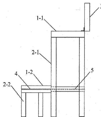
1. 一种双层式多用椅,包括支撑板、支撑腿和靠背(3),其特征是:上层支撑板(1-1)底部固接支撑腿一(2-1),下层支撑板(1-2)底部固接支撑腿二(2-2),下层支撑板(1-2)两侧的凸棱(4)可插接在支撑腿一(2-1)侧棱的滑道(5)内,上层支撑板(1-1)后端合页连接靠背(3)。
