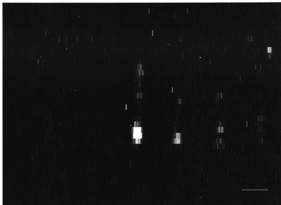
Пример карты распределения интенсивности фотолюминесценции наночастиц золота (масштабный отрезок 0,02 мм в правом нижнем углу)
