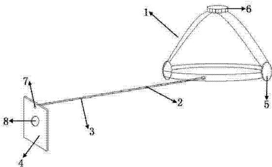
1. 一种头套式优势眼测定器,包括头套(1)、连接杆(2)和主眼板(4),其特征在于所述连接杆(2)的一端固定设置在头套(1)套沿的前侧中部,连接杆(2)的另一端穿过主眼板(4)上部竖直中心线处的滑孔(7)与主眼板(4)滑动相连,主眼板(4)上设有位于滑孔(7)下方的检测孔(8)。
