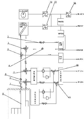
1. 一种利用可再生能源的冷热电多联供能源站,包括风力和 / 或太阳能发电装置和储能系统,其特征在于 :还包括太阳能光热组合装置、蓄热水箱、蓄冷水箱、地能水源热泵、风能空气源热泵、用户侧换热器和热泵电控系统,所述风力和 / 或太阳能发电装置产生的电通过公共直流母线与储能系统连接,热泵电控系统用电连接公共直流母线,所述公共直流母线上还设有 DC/AC 逆变器,所述 DC/AC 逆变器根据需要设计为离网模式或并网模式及单向或双向电能流动模式,所述光热组合装置与蓄热水箱相连通,光热组合装置中水与蓄热水箱中水可循环,蓄热水箱与地能水源热泵相连通,蓄热水箱中水与地能水源热泵中水可循环,光热组合装置与地能水源热泵相连通,光热组合装置中水与地能水源热泵中水可循环,地能水源热泵与置于地下的管路相连通,地能水源泵中的水与地下管路中的水可循环,地下管路中水与光热组合装置中水可循环,地下管路可向蓄冷水箱供给冷水,地能水源热泵与风能空气源热泵并联连接用户侧换热器。
