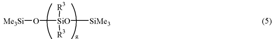
(式中、 $\text{R}^3$ は非置換又は置換の一価炭化水素基であり、 $g$ は25における粘度が20~1,000,000センチポイズとなるような整数であり、Meはメチル基を示す。)で表わされるトリメチルシリコキシ基を末端に有する直鎖状オルガノポリシリコキサンを(A)成分100重量部に対して1~50重量部含有する請求項1記載の室温硬化性オルガノポリシリコキサン組成物。 10
