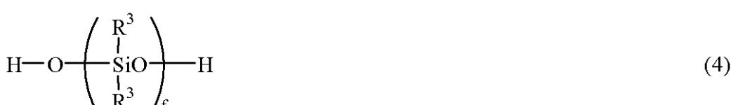
(式中、 $R^3$ は非置換又は置換の一価炭化水素基、 $f$ は25における粘度が20～1,000,000センチポイズとなるような整数である。)
