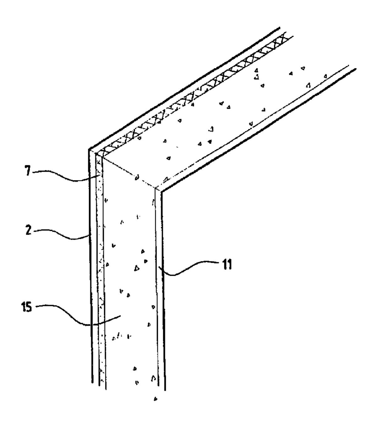
(57) Cette invention concerne une plaque de plâtre renforcée qui comprend une première couche de papier (11), un noyau fait d'un matériau à base de ciment (15), un treillis de renfort (7), ainsi qu'une autre couche de papier (2). Cette couche de papier (2) est adjacente au treillis de renfort (7) qui peut entrer en contact elle.
