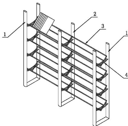
1. 一种组合书架,其特征在于包括一对支撑架和多个V型架,所述的支撑架上固定设置有多呈上下间隔排列的安装架,所述的安装架的数量大于等于所述的V型架的数量,所述的安装架由两条固定连接在所述的支撑架上且相互平行的支撑条组成,两条所述的支撑条之间设置有安装槽,所述的V型架包括两个V型支架,两个所述的V型支架之间固定连接至少两条设置在所述的V型支架两侧的横条,所述的V型支架插入所述的安装槽中,所述的横条架在所述的支撑条上。
