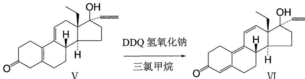
[0046] 化合物 V 10g (32.26mmol) 溶解在 300ml 氯仿中, 然后室温下加入 DDQ 10g (44.05mmol) 脱氢反应 2h。反应完全后过滤, 滤液用氢氧化钠溶液洗涤至中性, 后浓缩至干, 得到浅黄色结晶粉末, 然后用 50ml 乙酸乙酯重结晶得到孕三烯酮 (VI) (7.3g, 23.7mmol, 73.5%)。
