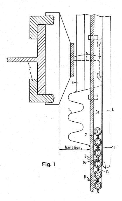
ONCE-THROUGH BOILER WITH WELDED TUBE SYSTEM
