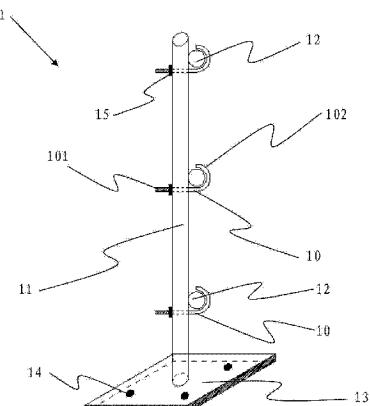
1. 一种临时安全防护栏杆,其特征在于:所述防护栏杆包括复数立杆和复数横杆,所述立杆与所述横杆之间通过拉钩固定连接,所述拉钩间隔布设于所述立杆上,所述立杆的底部固设有一底板。
