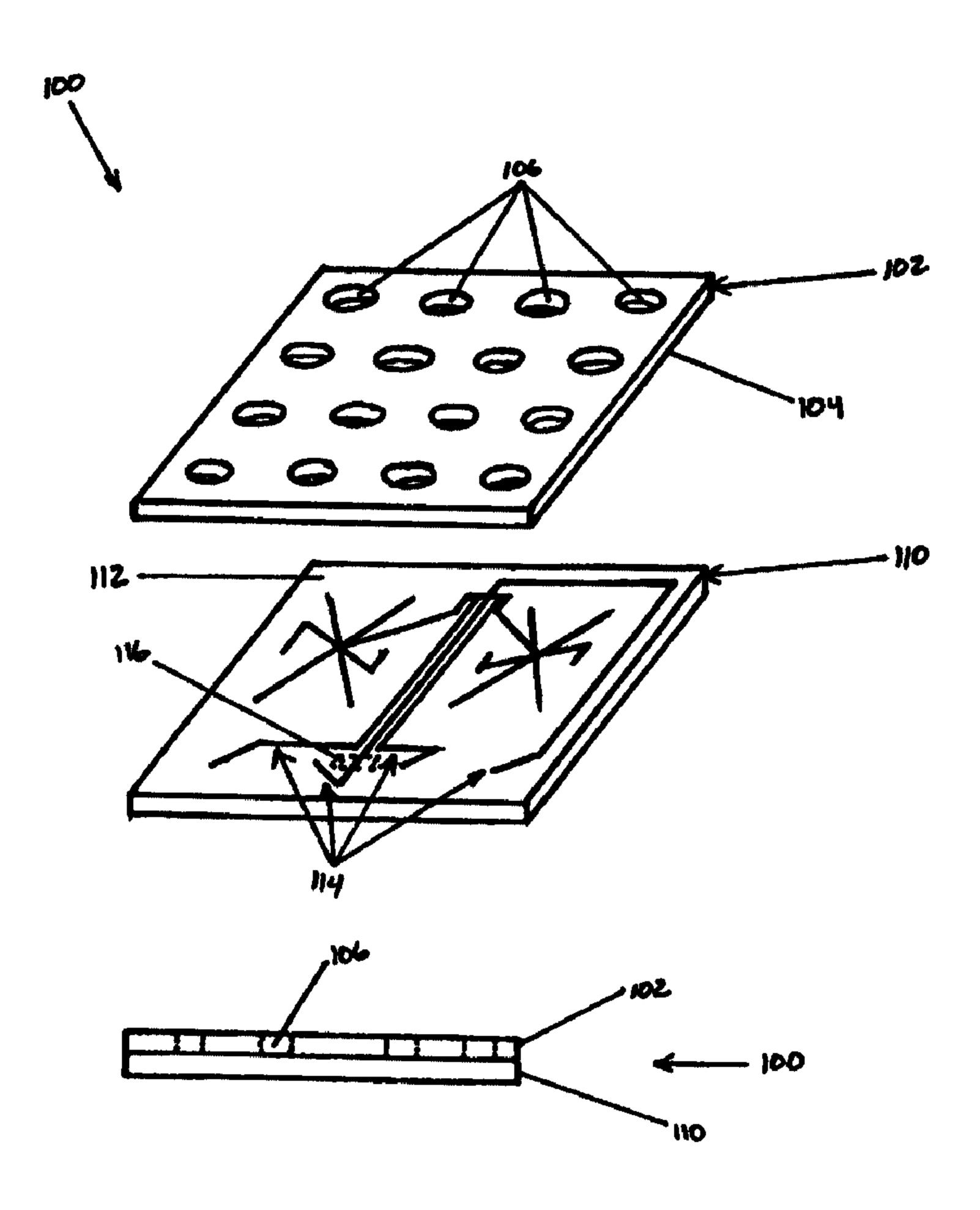
(57) La présente invention concerne des dispositifs et systèmes microfluidiques (100) faisant appel à des systèmes de détection optique, un ou plusieurs éléments optiques (106) de modification de lumière étant intégrés à la structure du corps (102) du dispositif microfluidique. Les dispositifs produits permettent d'effectuer au moins une partie des manipulations optiques comprises dans le procédé de détection optique utilisé.
