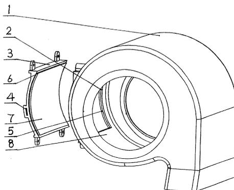
1、一种风幕机蜗壳，它包括蜗壳壳体，其特征在于：在蜗壳壳体正面置有通孔和可拆装的盖板。
