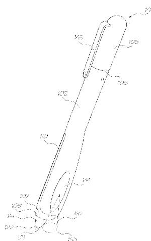
1. 一种传感器设备，它用于探测区域身份标识数据并且当这个传感器设备相对一个表面的一个区域进行移动时产生移动数据，这个区域身份标识数据表示这个区域的身份标识，这个移动数据标识这个传感器设备相对该区域的移动，该表面的上面放置有表示与这个表面相关的至少一个区域的编码数据，该传感器设备包括：
