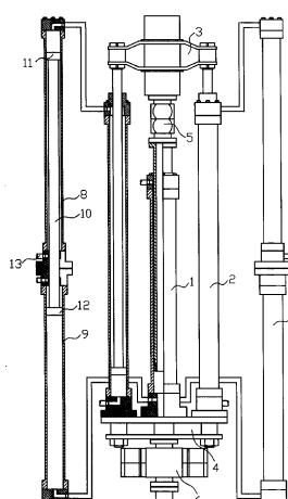
1、压力平衡式静密封带压修井作业装置，它包括有伸缩管套（1）、升降液压缸（2）、上横梁（3）、下横梁（4）、上防喷器（5）、下防喷器（6），其特征在于，它还包括有压力平衡液压缸（7），压力平衡液压缸（7）的缸筒的一端通过管线与伸缩管套（1）的下端管腔相连通。
