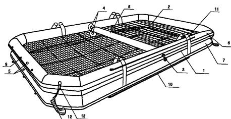
1、一种救援平台，其特征在于它是由框架（1）和固定在框架（1）之间的底网（2）组成，所述的框架（1）为可充放气的气囊，框架（1）上设有进气口（3）、排气口（4）、安全泄气阀（5）。
