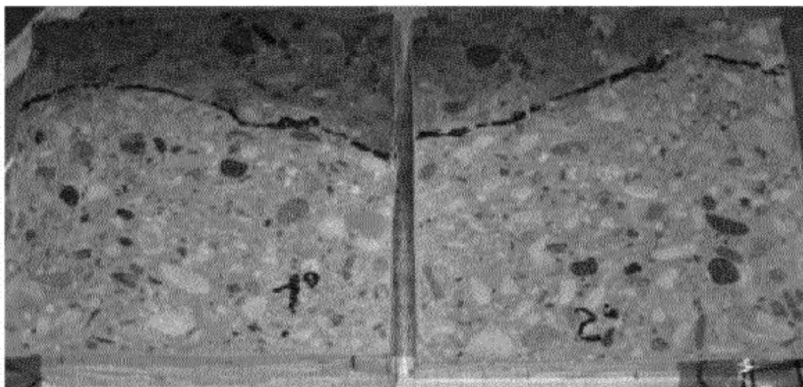
Figura 9. Prueba de penetración de agua a alta presión en una probeta de hormigón preparada sin el acelerador descrito en el ejemplo 5-10 de la presente invención (Ejemplo 19).
