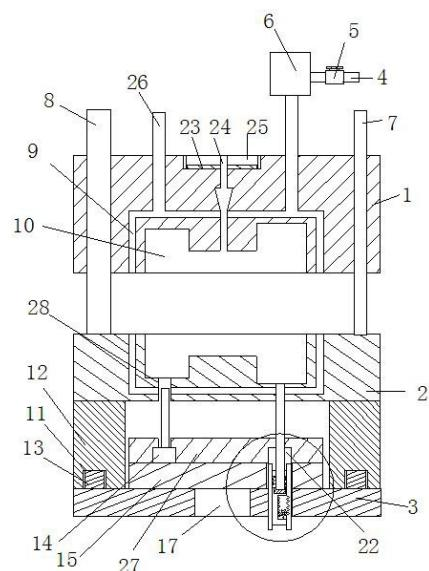
1. 一种快速脱模的注塑模具，包括上模板(1)和下模板(2)，其特征在于：所述上模板(1)的正中间开设有注塑口(25)，所述上模板(1)和下模板(2)中间设有模仁(10)，模仁(10)的四周开设有冷却槽(9)，所述下模板(2)下表面的四周固定安装有模脚(12)，模脚(12)的下方设有下固定板(3)，模脚(12)的下表面正中间均开设有限位孔(11)，下固定板(3)与限位孔(11)相对应的位置设置有限位柱(13)，所述下固定板(3)的上表面设有顶针底板(15)，顶针底板(15)的上表面固定安装有若干第一顶针(14)和第二顶针(22)，所述顶针底板(15)的上方设置有顶针面板(27)，顶针面板(27)和下模板(2)上开设有与第一顶针(14)和第二顶针(22)位置相对应的顶针孔(28)。
