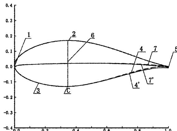
1. 一种基于尖尾缘翼型设计的后加载钝尾缘翼型,包括前缘、吸力面、压力面和钝尾缘,所述钝尾缘翼型以及尖尾缘翼型皆分别通过翼型最大厚度线分界成前部翼型和后部翼型,其特征在于:所述钝尾缘翼型的前缘、吸力面以及前部压力面与尖尾缘翼型的相应部分形状一致,所述钝尾缘通过尖尾缘翼型的尾缘点垂直向下延伸一定的偏移量形成,钝尾缘厚度 $\delta$ 在翼型最大厚度的2.5%-3.5%之间选取。
