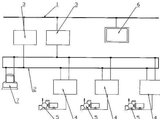
1. 工业总线煤矿水泵房排水冗余控制器，其特征在于，包括工业总线（1）、工业总线环网（2）、泵房监控主控制器（3）、泵房监控分控制器（4）、水泵（5）和操作站（7）；有两个泵房监控主控制器（3），每个泵房监控主控制器（3）连接工业总线（1）和工业总线环网（2）；共有与水泵（5）数量相同的泵房监控分控制器（4），泵房监控分控制器（4）连接水泵（5）的电机控制器，每个泵房监控分控制器（4）还连接工业总线环网（2）；操作站（7）连接工业总线环网（2）。
