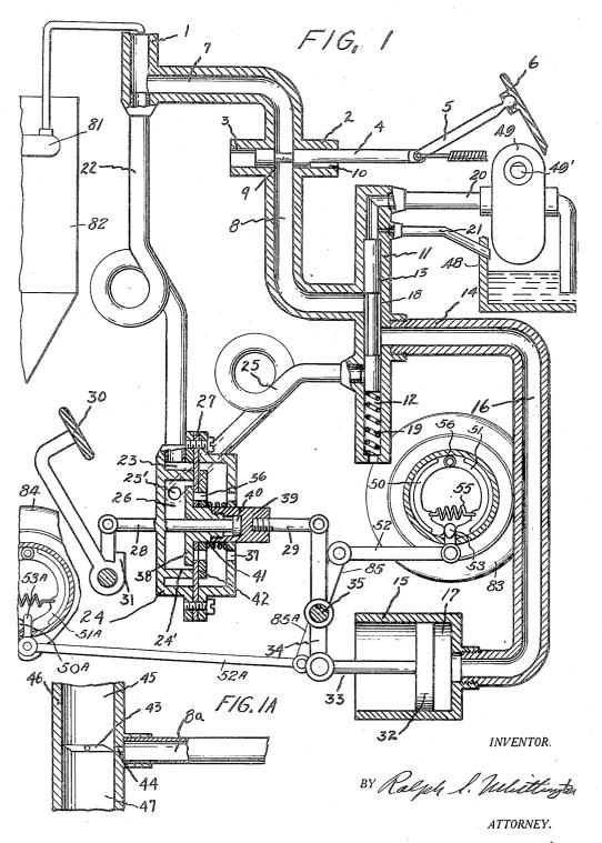
AUTOMATIC CONTROL OF THE BRAKES OF A MOTOR VEHICLE
