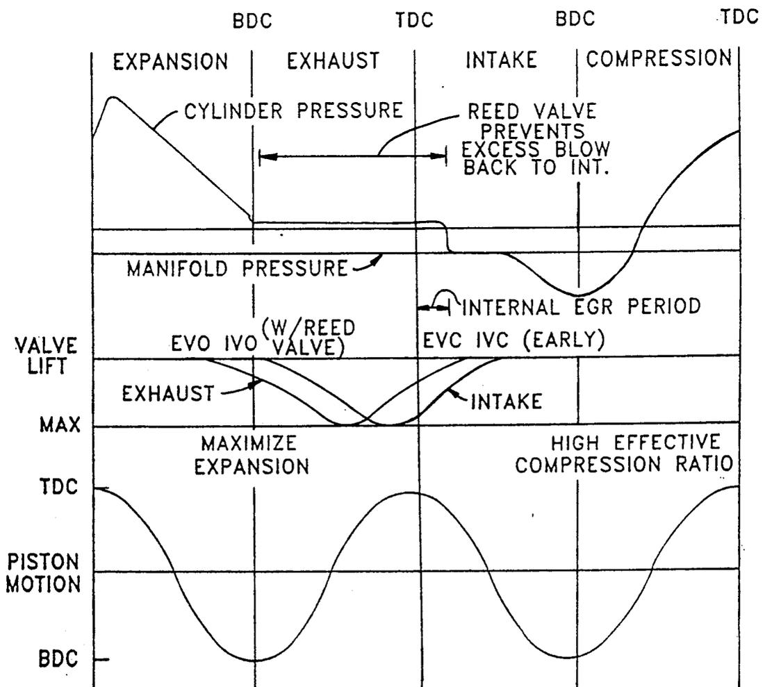
CAM PHASING & ENGINE OPERATION
