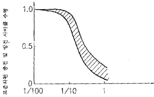
$$\left( \begin{array}{l} \text{윤극 표면에서 도전성 재료의 표면} \\ \text{불규칙도의 최대 높이} \end{array} \right) \times 1/2 - \left( \begin{array}{l} \text{중앙선 평균 조도} \end{array} \right)$$
