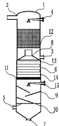
1. 气液混提一体化碘回收装置,其构造由塔体(1)底段、塔体(1)中段及塔体(1)顶段三段构成,其特征在于:在塔体(1)顶段上方设有出气口(2),塔体(1)底段下方和塔体(1)中段分别设有底部出液口(7)和中部出液口(3),塔体(1)底段和塔体(1)顶段分别设有下进液口(15)和上进液口(4),塔体(1)底段下方设有进气口(5),塔体(1)中段设有热交换段(6),并设有冷却水出水口(13)和冷却水进水口(14),热交换段(6)的下方安装有鱼网捕液器(11),所述热交换段(6)由圆台塔体和倒漏斗(8)构成,所述塔体(1)底段安装有气液混合分离器(9)。
