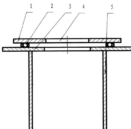
1. 一种可旋转的火锅桌，包括固定桌面，其特征在于：固定桌面下面装有桶状的桌腿，固定桌面上部装有旋转轨道和旋转桌面，旋转桌面及固定桌面中心有同心的火锅放置孔。
