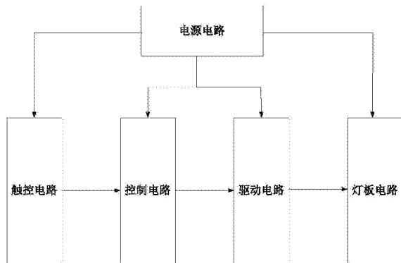
1. 一种蓝牙洗墙灯电路，包括电源电路、控制电路、触控电路、驱动电路和灯板电路，所述电源电路与其他电路连接并提供电能，触控电路与控制电路连接，将信号传输给控制电路，控制电路与驱动电路连接，驱动电路与灯板电路连接，其特征在于：所述控制电路为使用BTLE220芯片的蓝牙控制电路，所述驱动电路为使用MP2340芯片的驱动电路，所述驱动电路为四个电路结构相同的RGBW电路组成，每个RGBW电路通过一个电阻R11与控制电路连接，电阻R11连接三极管Q1的基极，三极管Q1的发射极接地，集电极接MP2340芯片的EN/DIM引脚，EN/DIM引脚通过电阻R10接地，VIN引脚通过电阻R6接EN/DIM引脚，VIN引脚通过等电势12V，VIN引脚通过电容C9接地，电容C9两端并联电容C10，BST引脚通过串联电阻R1和电容C1接到SW引脚，SW引脚接电感L1构成增加亮度的输出脚LIGHT+，FB引脚接电阻R4构成降低亮度的输出脚LIGHT—，LIGHT+和LIGHT—之间接电容C3，电容C3两端并联电容C2，输出脚LIGHT—通过电阻R7接地，电阻R7两端并联电阻R8，GND引脚接地。
