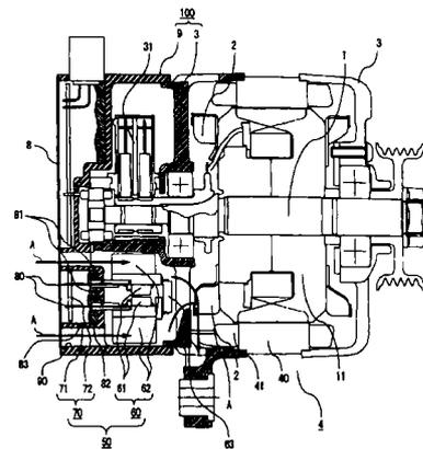
1. 一种逆变器一体型旋转电机,由在容器内放置交流电动机及逆变器装置而构成,所述交流电动机具有固定在转子上的风扇,利用所述风扇旋转,从所述容器外吸入空气,其特征在于,
