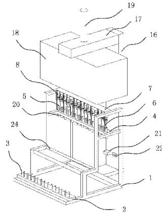
1. 一种线筒分绕机，包括机架(1)，所述的机架(1)上固定有安装板一(2)和设置在安装板一(2)斜上方的安装板二(4)，所述的安装板一(2)上固定有若干用于放置主线筒的插筒杆一(3)，所述的安装板二(4)上设置有若干用于放置副线筒的插筒杆二(5)，其特征在于，所述的插筒杆二(5)的一端设有能驱动插筒杆二(5)转动的驱动机构，所述的插筒杆二(5)的另一端为插入端，所述的插筒杆一(3)与插筒杆二(5)之间设有能将插筒杆一(3)上的纱线导入到插筒杆二(5)上的导线杆(6)，所述的导线杆(6)与插筒杆二(5)平行设置，所述导线杆(6)的一端上开设有一能供纱线通过的通孔(61)，且所述的导线杆(6)上还设有能驱动导线杆(6)上下移动的伸缩机构。
