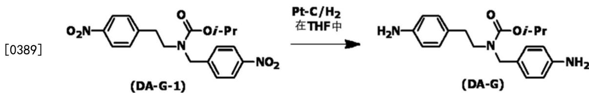
[0390] 使N-异丙氧基羰基-N-2-(4-硝基苯基)乙基-N-4-硝基苄基胺(30.0g、77.4毫摩尔)溶解于四氢呋喃(120g)中,加入3质量%铂-碳(3.0g),在氢气气氛下、室温下搅拌4小时。用HPLC确认原料的消失,通过过滤去除催化剂。然后,将滤液浓缩,进行干燥,从而得到DA-G(淡黄色液体、产量:25.0g、收率:99%)。
