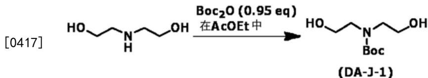
[0418] 使二乙醇胺 (20.0g、190毫摩尔) 溶解于乙酸乙酯 (60.0g) 中, 在25°C下用20分钟滴加二碳酸二叔丁酯 (39.4g、180毫摩尔), 搅拌1小时。用气相色谱确认原料的消失, 将反应溶液通过硅胶柱 (洗脱液: 乙酸乙酯) 后, 进行浓缩、干燥, 从而得到N-叔丁氧基羰基二乙醇胺 (DA-J-1) (无色液体、产量: 35.4g、收率: 92%)。
