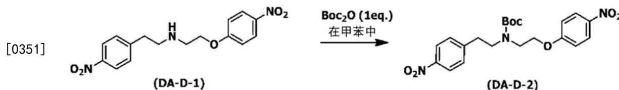
[0352] 使N-(2-(4-硝基苯基)乙基-N-(2-(4-硝基苯氧基)乙基)胺(5.55g、16.7毫摩尔)和三乙胺(1.86g、18.4毫摩尔)溶解于甲苯(11.1g)中,滴加二碳酸二叔丁酯(4.02g、18.4毫摩尔)的甲苯溶液(15.0g)。然后,在70℃下搅拌1小时,用HPLC确认原料的消失。接着,加入水(55.0g)洗涤2次。在室温下自然冷却后,加入正庚烷(22.1g),析出固体后,冷却至5℃,搅拌30分钟。然后,将析出物过滤,进行干燥,从而得到N-叔丁氧基羰基-N-(2-(4-硝基苯基)乙基-N-(2-(4-硝基苯氧基)乙基)胺(黄色粉末、产量:6.6g、收率:93%)。
