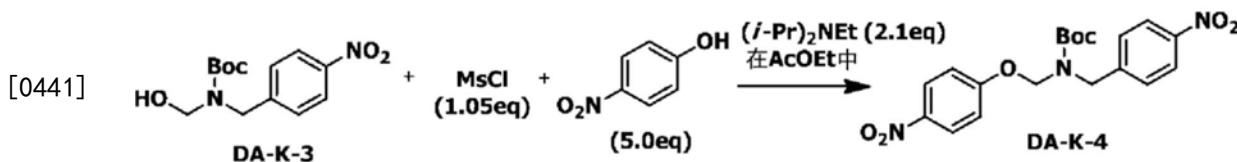
[0442] 使N-叔丁氧基羰基-N-羟基甲基-4-硝基苄基胺(142mg、0.50毫摩尔)溶解于乙酸乙酯(0.50g)中,加入二异丙基乙基胺(71.4mg、0.55毫摩尔),在0℃下加入甲烷磺酰氯(60.4mg、0.53毫摩尔),搅拌30分钟。
