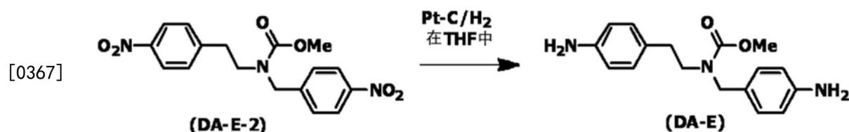
[0368] 使N-甲氧基羰基-N-2-(4-硝基苯基)乙基-N-4-硝基苄基胺 (30.0g、83.5摩尔) 溶解于四氢呋喃 (120g) 中, 加入3质量%铂-碳 (3.0g), 在氢气气氛下、室温下搅拌4小时。用HPLC确认原料的消失后, 通过过滤去除催化剂。接着, 将滤液浓缩, 进行干燥, 从而得到DA-E (淡黄色液体、产量:25g、收率:98%)。
