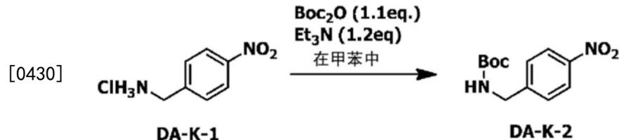
[0431] 使4-硝基苄基胺 (5.00g、26.5毫摩尔) 悬浮于甲苯 (50g) 中, 在室温下加入三乙胺 (3.22g、31.8毫摩尔), 在室温下用15分钟滴加二碳酸二叔丁酯 (6.36g、29.2毫摩尔), 在60℃下搅拌2小时、在室温下搅拌16小时, 用HPLC确认原料的消失。
