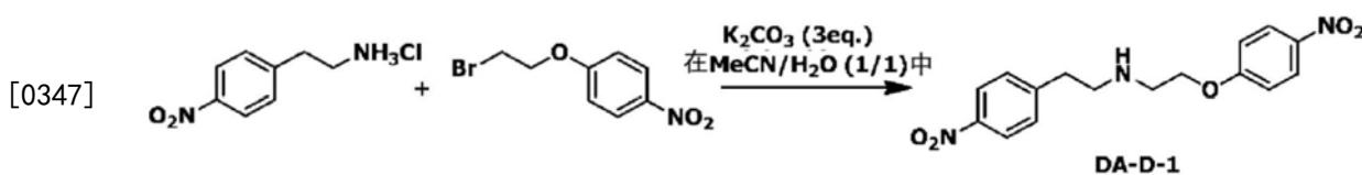
[0348] 使2-(4-硝基苯基)乙基胺盐酸盐(7.65g、37.8毫摩尔)溶解于水(15.3g)和MeCN(乙腈)(15.3g)中,进而加入溶解于水(22.5g)的碳酸钾(15.7g、114毫摩尔),接着在20℃下
