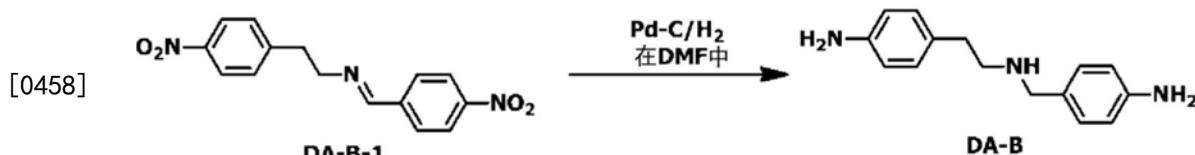
[0459] 将N-(2-(4-硝基苯基)乙基)-N-(4-硝基苄亚基)胺(3.50g、11.7毫摩尔)加入到DMF(35.0g)中,加入5质量%钯-碳(0.350g),在氢气气氛下、室温下搅拌11天。用HPLC确认原料的消失,通过过滤去除催化剂。然后,将滤液浓缩、进行干燥,从而以褐色油形式得到DA-B(产量:2.82g、收率:100%)。
