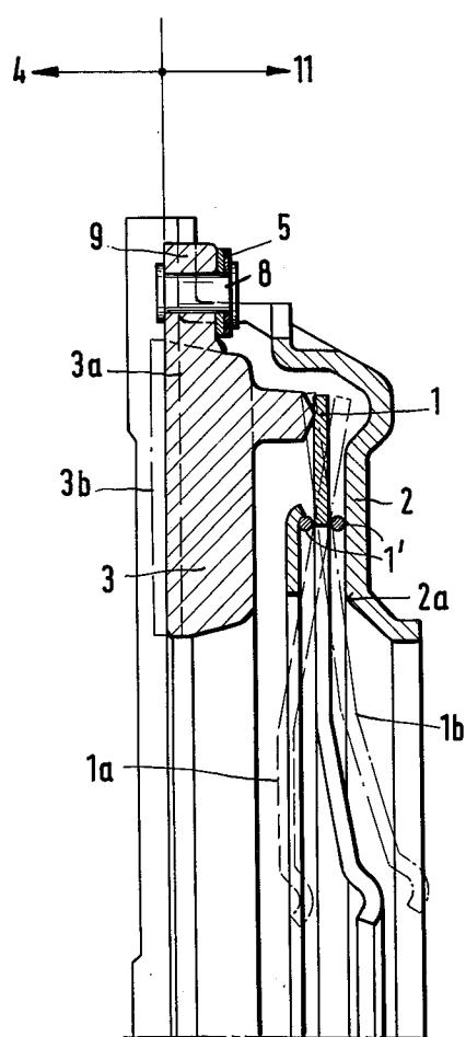
**FRICITION CLUTCH, ESPECIALLY FOR MOTOR VEHICLES**
