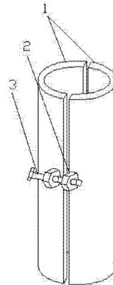
1. 一种真空开关储能弹簧拆装专用工具,其特征在于:包括至少两块弧形板,所述弧形板通过连接机构相互连接形成用于夹持储能弹簧的筒状结构。
