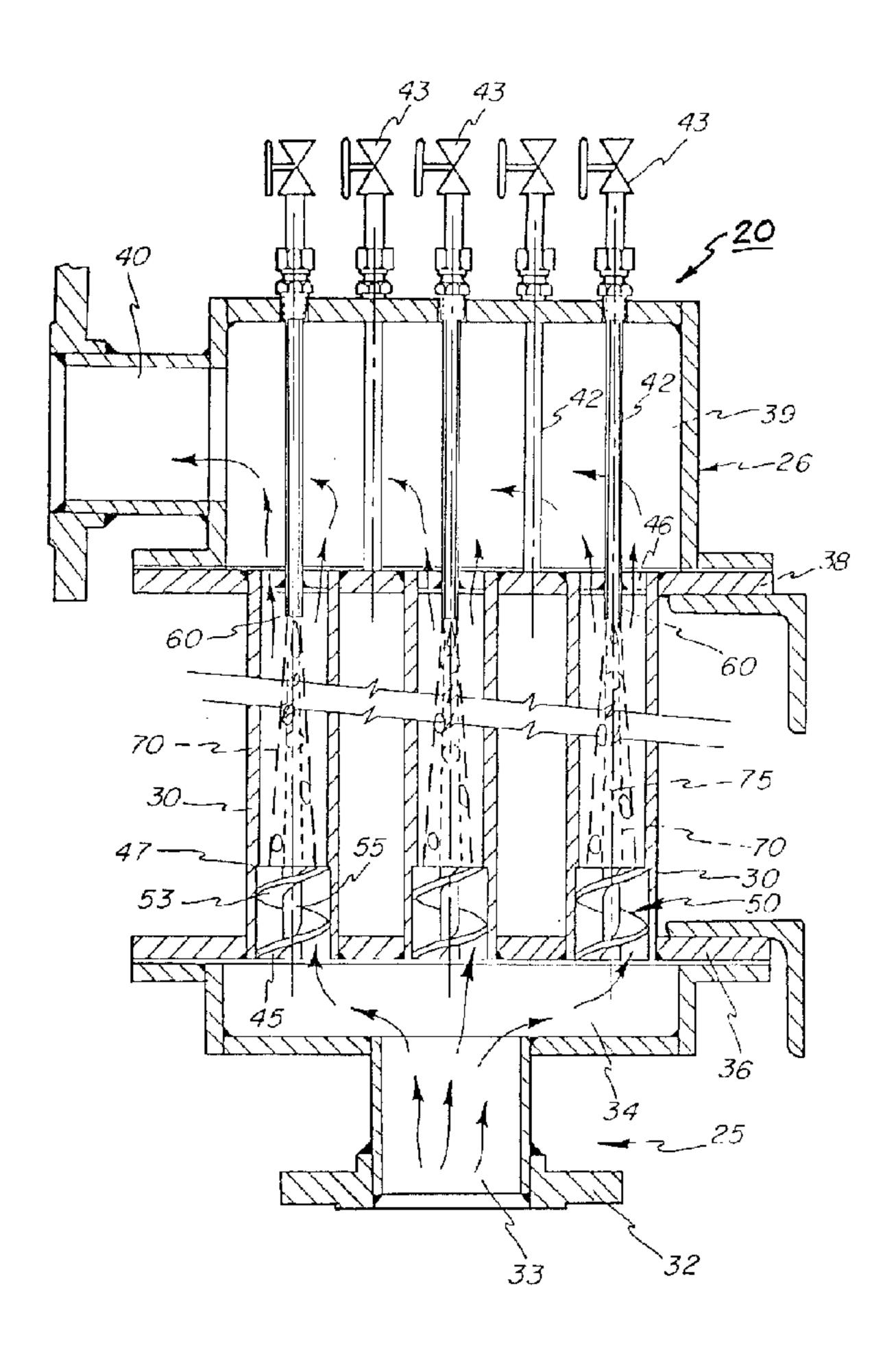
(57) Dispositif de désaération servant à supprimer de l'air entraîné d'un liquide de revêtement de papier et comprenant un tube à tourbillons cylindrique (30) comportant une pièce encastrée produisant des tourbillons (50) constituée par une spirale (53) entourant
