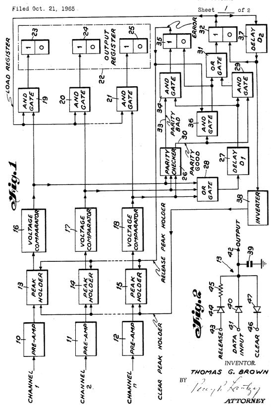
ERROR CORRECTION CIRCUIT FOR DIGITAL RECORDING SYSTEMS
