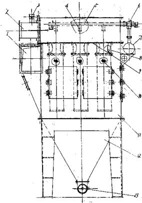
1. FSQC 脉冲除尘器由箱体、滤筒、清尘装置三部分组成。中箱体长度方向外侧设进风道。当含尘空气进入风道后，风速扩散下降，并均匀缓慢地进入中箱体滤筒四周空间，经滤筒过滤后进入上箱体，由风机输送排入大气。
