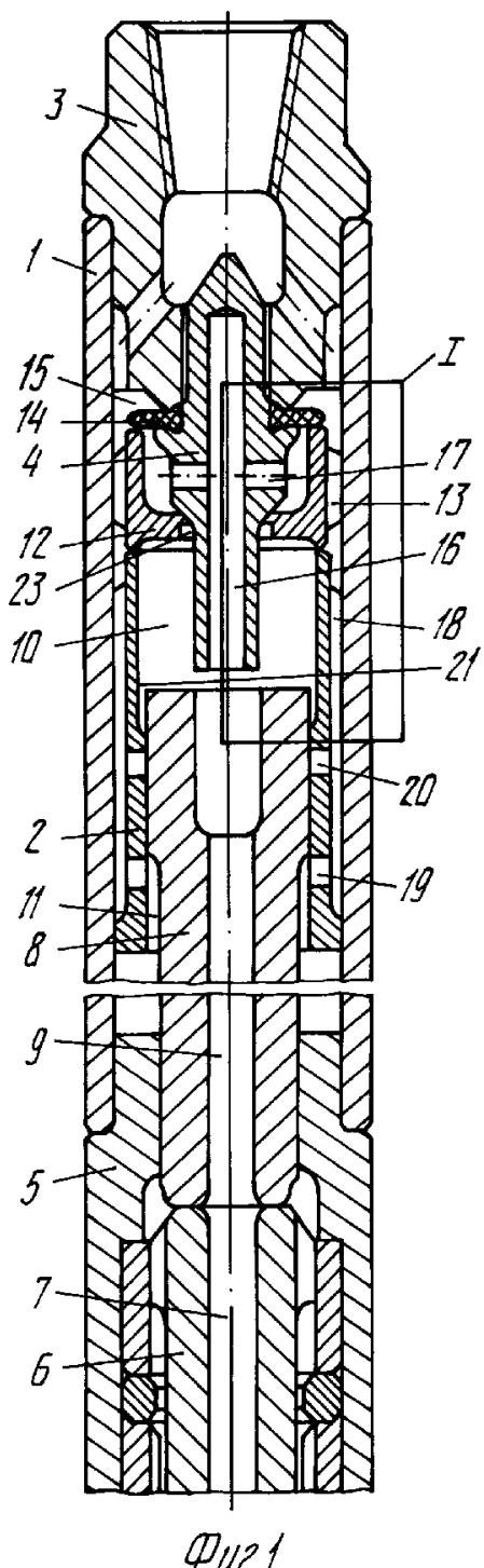
Предлагаемая ударная машина относится к буровой технике, а именно к погружным устройствам для ударно-вращательного бурения скважин и может найти применение в геологоразведке, бурения на воду, в горном деле.
