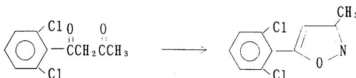
2,6-ジクロロベンゾイルアセトン 104.6 g をエタノール 330 ml に溶解し、塩酸ヒドロキシルアミン 35.8 g を添加後、加熱還流下に 1 時間攪拌した。反応液を冷却後、氷水に注加して、酢酸エチルで抽出を行い、有機層を水洗後、無水硫酸マグネシウムで乾燥した。溶媒を減圧濃縮して、2,6-ジクロロ-1-(3-メチルイソキサゾール-5-イル)ベンゼン 90.3 g を得た。
