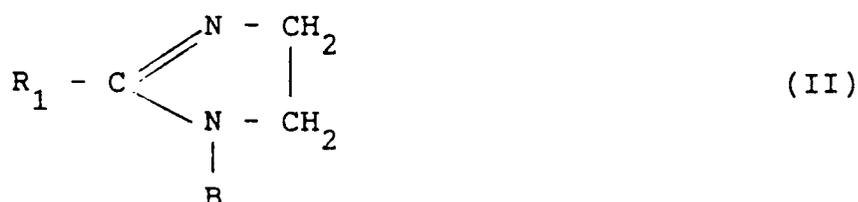
dans laquelle  $\text{R}_1$  et B ont la signification données plus haut, avec de l'eau dans un rapport molaire de 1 : 8 à 1 : 20 à des températures entre 50 et 130 °C sous pression atmosphériques ou sous une faible pression effective au cours de 1 à 24 heures, en un mélange d'amidoamines des formules III et IV.
