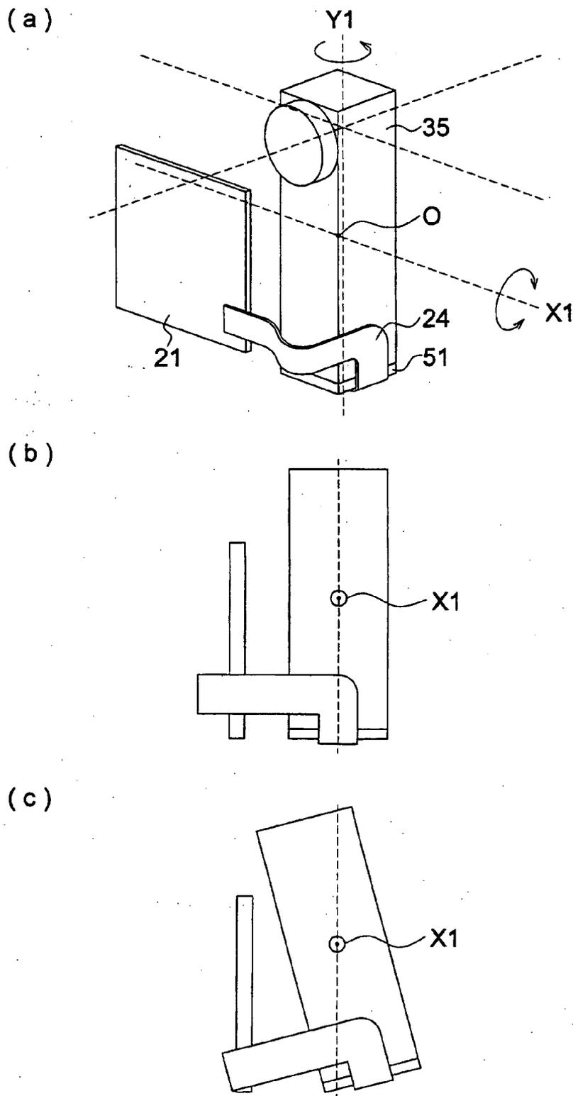
**CAMERA SHAKE COMPENSATION MECHANISM
