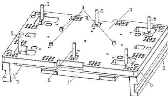
1. 一种公用治具底座,其特征在于:所述公用治具底座包括底座垫脚、底座平台、顶料平台、气缸、定位销和顶料针,所述底座平台固定连接于所述底座垫脚的上端,所述顶料平台位于所述底座平台的下方,所述气缸位于所述顶料平台的下方,所述顶料平台与所述气缸的上下运动的活塞杆固定连接,所述底座平台的上端固定连接至少三个所述定位销,所述顶料平台的上端固定连接多个所述顶料针,所述底座平台对应于这些顶料针设置有多个顶料针通孔,这些顶料针穿过所述底座平台的顶料针通孔向上延伸。
