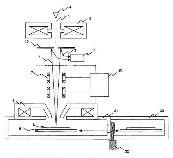
30···LOAD LOCK CHAMBER 31····VACUUM SAMPLE CHAMBER
