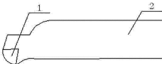
1. 一种钢管热封口方法专用车刀,包括刀头(1)和刀杆(2),其特征在于:刀头(1)的工作部为球面形。
