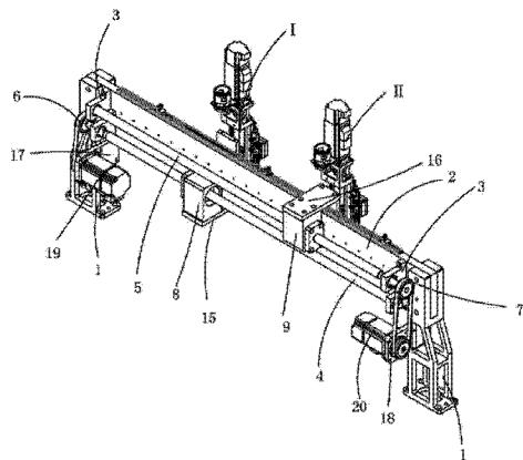
1. 一种互补型机械手装置,其特征在于:它包括支撑立柱,所述支撑立柱有两个,两个支撑立柱之间安装有丝杆安装板;所述丝杆安装板的背部通过丝杆座安装有两组丝杆,分别为丝杆a和丝杆b,丝杆a的左端安装有同步带轮a,丝杆b的右端安装有同步带轮b;所述丝杆a和丝杆b上分别安装有丝杆滑座a和丝杆滑座b;所述丝杆安装板的正面安装有一滑轨,滑轨上配合安装有滑块a和滑块b,滑块a和滑块b上分别安装有移动板a和移动板b,所述丝杆滑座a通过连接板a与移动板a连接在一起;所述丝杆滑座b通过连接板b与移动板b连接在一起;所述移动板a上连接一Z轴机构a,所述移动板b上连接一Z轴机构b;所述Z轴机构a和Z轴机构b结构相同;
