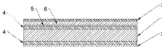
1. 一种新型防火防水的胶合板,其特征在于,包括芯板、底板、装饰板、玻镁板、氧化铝层和高密度纤维板,芯板的上下端面均设有玻镁板,一玻镁板的底端面设有底板,芯板和底板选用阻燃实木桦木为材料,另一玻镁板的顶端面设有氧化铝层,氧化铝层的另一端面设有高密度纤维板,高密度纤维板的另一端面设有装饰板,芯板、底板、装饰板、玻镁板和氧化铝层以及高密度纤维板之间的是选用WBP胶水胶合连接。
