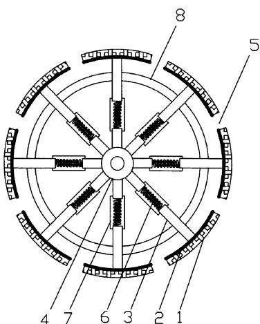
1、一种防爆车轮，包括轮毂、连接轮毂与车圈的轮辐、套装在车圈上的轮胎，其特征在于：所述的车圈径向设有一个以上的断口，每两断口之间的车圈上装设有实心橡胶轮胎，每两断口之间的轮毂与车圈之间设有至少一个轮辐，该轮辐上设有减震装置。
