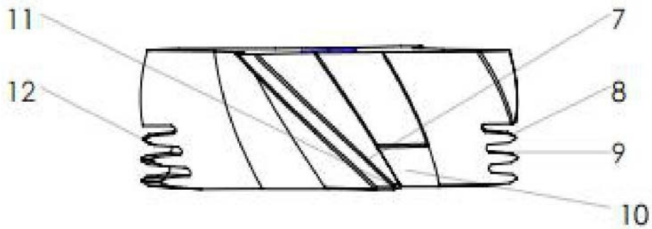
7.周刃；8.环形牙锥台；9.槽背；10.容屑槽；11.刀尖 R 角；12.切屑牙；
